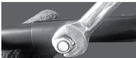
5. Skyv gummibussingen på riggrøret. Pass på at hullet i bussingen sitter over hullet på røret. Bussingen har en knott som skal passe mot et spor i festehullet. Skyv riggrøret i festehullet, sett skruene i og trekk til. **Obs!** Fordi strømkabelen går gjennom riggrøret kan det hende at du må skyve kabelen til siden med en passende gjenstand for å få skruene gjennom.
