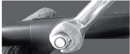
5. Skjut på gummibussningen på riggröret, se till att hålen i bussningen sitter över hålen i röret. Bussningen har en pressning som ska passa mot en skåra i fästhållet. Skjut ner riggröret i fästhållet, sätt i skruvarna och dra fast. **Obs!** Eftersom nätkabeln löper genom riggröret kan du behöva peta kabeln åt sidan med ett lämpligt föremål för att få igenom skruvarna.
