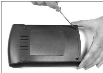
4. Stäng chassit och skruva tillbaka skruvarna.
