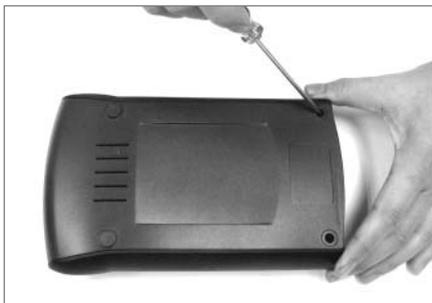
4. Sulje runko-osa ja kiinnitä ruuvit paikoilleen. Valmis! Tarkasta, että jäähdyttävä tuuletin toimii, kun kytket jännitteenmuuntimen. Jos jäähdyttävä tuuletin ei toimi, avaa kuori uudelleen ja tarkasta, ettei mikään osa ole puristuksissa.
