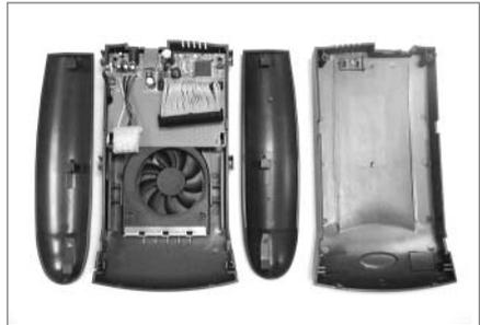
1. Irrota kumisuojat ja poista laitteen alapuolella olevat ruuvit. Avaa kuori ja irrota sivukappaleet painamalla niitä ylöspäin
