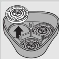
**4** Irrota terät ja teräsäleiköt ja puhdista ne laitteen mukana toimitetulla harjalla.
