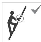
Håll i stegen med ett säkert grepp när du klättrar på den. Håll alltid fast dig i stegen eller vidta andra säkerhetsåtgärder om du inte kan hålla dig i stegen när du arbetar från den.
