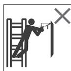
Vältä käyttämästä tikkaita töissä, joissa tikkaisiin kohdistuu voimakasta sivuveimaa, esim. tikkaiden sivussa olevan kiinteän materiaalin poraamista.
