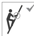
Hold i stigen med et sikkert grep når du klatter i den. Hold deg alltid fast i stigen eller benytt andre sikkerhetsanordninger hvis du ikke kan holde deg fast når du jobber fra den.
