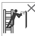
Das Ausführen von Arbeiten von der Leiter aus vermeiden, die eine seitliche Krafteinwirkung auf die Leiter mit sich bringen, also z. B. zu einer Seite hin in festes Material bohren.
