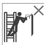
Undvik att använda stegen till arbeten som medför en sidokraft mot stegen, som t.ex borrhning åt sidan i fast material.
