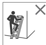
Fristående stege ska inte användas som lutande stege om den inte är konstruerad för det.
