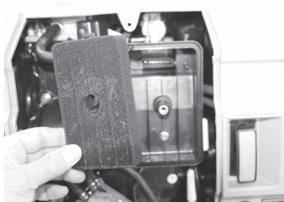
1. Skruva loss skruven (18) som håller fast serviceluckan (19) och ta bort luckan.
