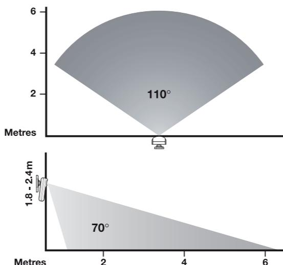
1. Seinään asennus: Kiinnitä pidike seinään pakkuksen kahdella ruuvilla ja käytä tarvittaessa myös tulppia seinämateriaalista riippuen. Sopiva asennuskorkeus on noin 1,8–2,4 m.
