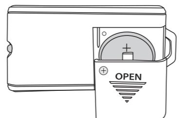
Fjärrkontrolen har ett fabriksmonterat batteri. Skjut upp batteriluckan och avlägsna skyddsplasten innan fjärrkontrolen tas i bruk.
