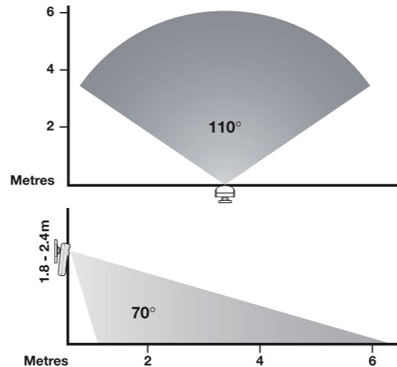
1. Ved veggmontering: Fest holderen godt på veggen med de to medfølgende skruene og ev. med plugger, avhengig av underlaget. Passende monteringshøyde er ca. 1,8-2,4 m.
