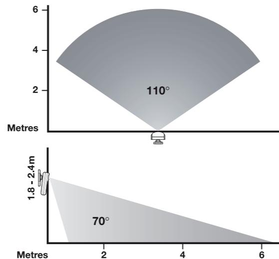
1. Vid väggmontering: Fäst hållaren ordentligt på väggen med de två medföljande skruvarna och ev. också pluggarna beroende på underlag. Lämplig monteringshöjd är ca 1,8–2,4 m.
