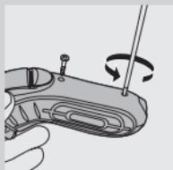
**3** Irrota laitteen takaosassa olevat kaksi ruuvia ja poista sitten kuoren takapaneeli.
