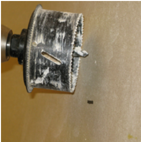
Använd 74mm multifräs och sätt borsten i en av markeringarna från piggarna.
