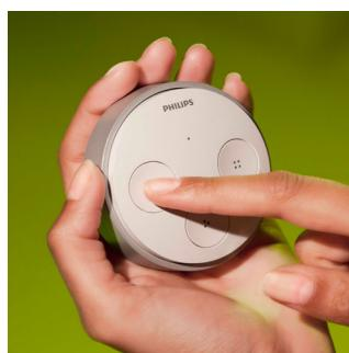
Philips Hue Tap nutzt die kinetische Energie des Tastendrucks. Daher werden keine Batterien benötigt.
