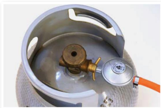
Kaasusäiliö ja siihen asennettu paineenalennusventtiili
