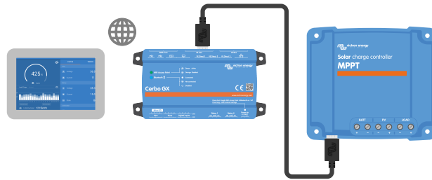
Anslutning av appen VictronConnect via LAN eller internet (VRM-portal) med en GX-enhet (exempelvis en Cerbo GX)
