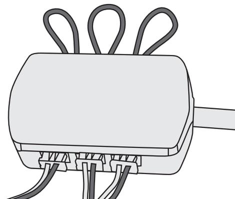
2. För upp kablar och armaturer i hålen, se till att armaturerna sitter fast ordentligt och anslut kablarna till förgreningsdosan.
