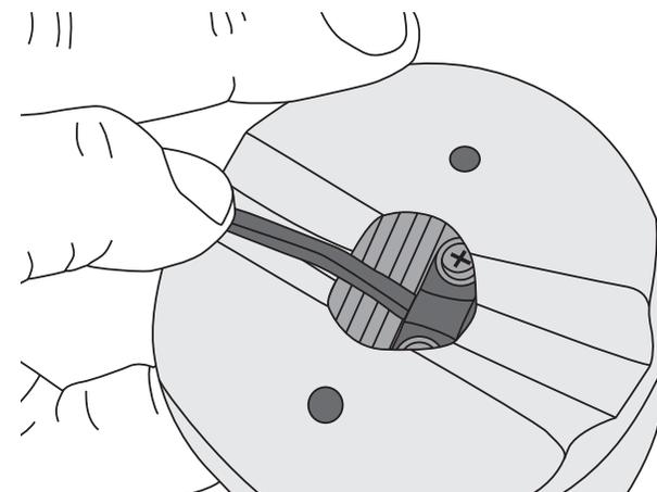
2. Varmista, että johto on rasian pohjan uurteessa ja kiinnitä rasia kattoon pakkauksen ruuveilla.
