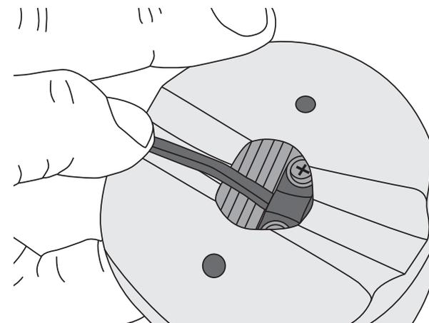
2. Se till att sladden ligger i skåran i dosans botten och fäst metalldosan i taket med medföljande skruv.
